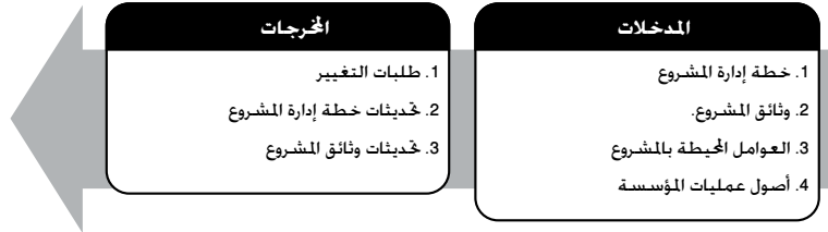
الشكل 23-3. وضع خطة الاستجابة للمخاطر: المدخلات والمخرجات
